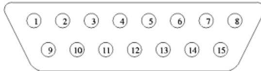
DB15 vue extérieure connecteur mâle looking into a male connector
